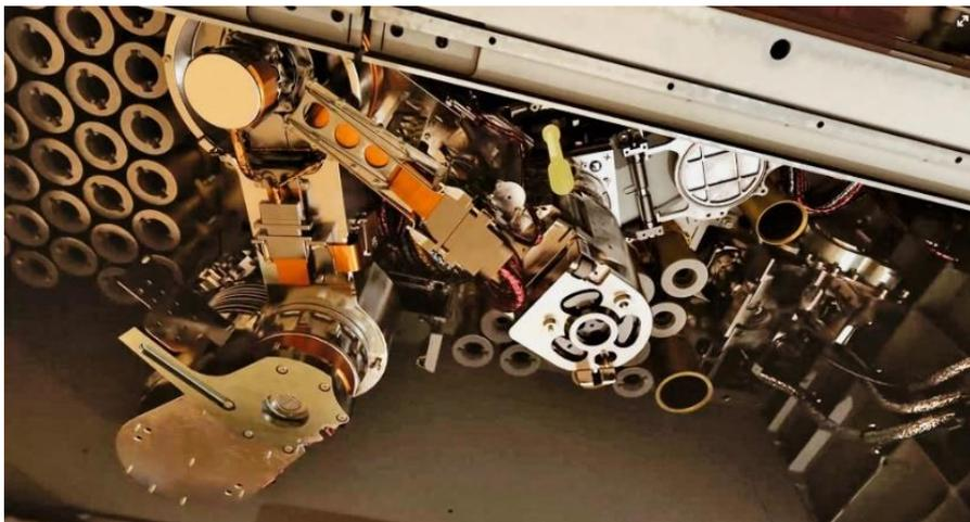
机械手臂将土壤样本送往体积检测和图像扫描站，然后送到密封站进行密封，最后再送至临时存放站——整个过程全自动完成。
