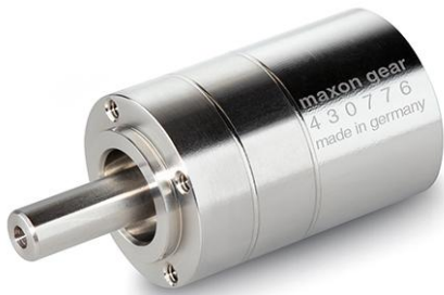
图 2：可消毒处理的行星齿轮箱 GP 19 M，允许持续转矩为 0.315 Nm，适用于高达 40 000 rpm 的电机转速。
